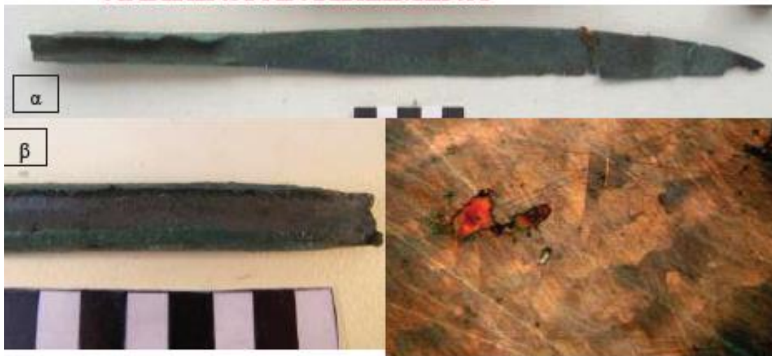
α) Μάχαιρα MX 605 β) Λεπτομέρεια της λαβής γ) Μικροδομή στο δείγμα από τη ράχη, 800x
