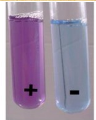
Εικόνα 1. Αντίδραση διουρίας (θετικός μάρτυρας αριστερά και αρνητικός δεξιά)
